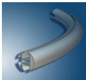
2-kanaal peesprofiel brut; rond 30 mm voor pees Ø=7-10 mm Max. buiglengte: 5500 mm Radius individueel > 250 mm
