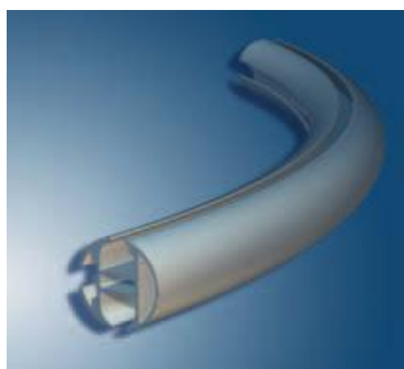
2-kanaal peesprofiel geanodiseerd; rond 30 mm voor pees Ø=7-10 mm Max. buiglengte: 5500 mm Radius individueel > 250 mm
